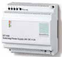
ST1108 Schaltnetzteil 24V DC 4,2 A Für max. 8 Jalousien DIN-Schienenmontage REG Maße: 5 TE 90x91x56 mm (BxHxT)
